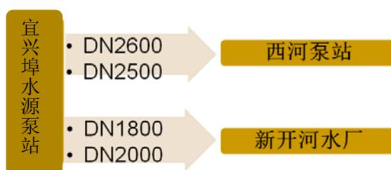
图 1 宜兴埠水源泵站原水出厂干管输水示意图
